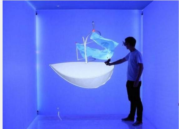
Abb. 6: Freiformflächengestaltung in einem 6-Wand-Projektionsraum "CAVE" [Bild: Fraunhofer IPK]
