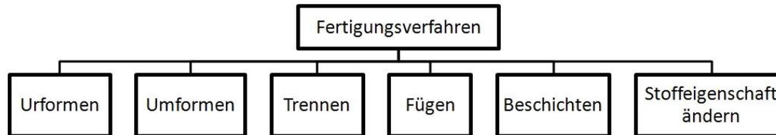
Bild: Hauptgruppen Fertigungsverfahren nach DIN 8580
